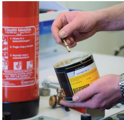
Szelepszár zsírozása, fejszerelvény összeszerelése
