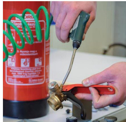
A fejszerelvény kifűvése sűrített levegővel
