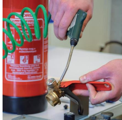
A fejszerelvény kifúvása sűrített levegővel
