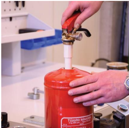
Komplett fejszerelvény függőleges behelyezése a tartályba
