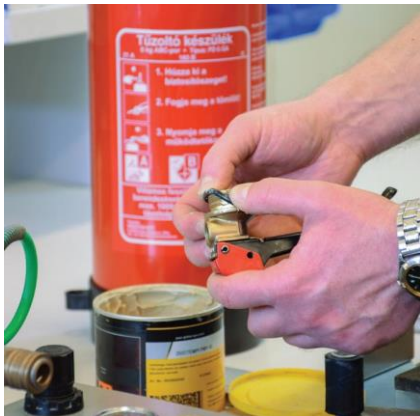
Új O-gyűrű felhelyezése minden karbantartáskor
