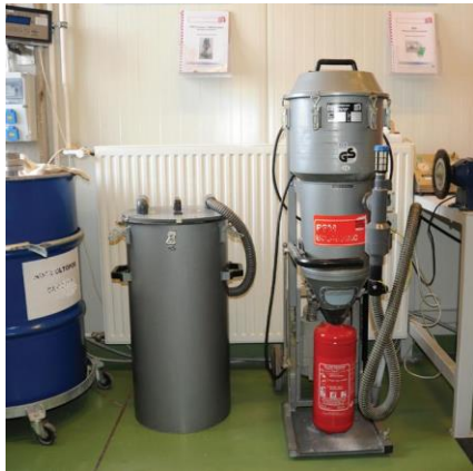
Porvisszatöltés zártrendszerű berendezéssel
