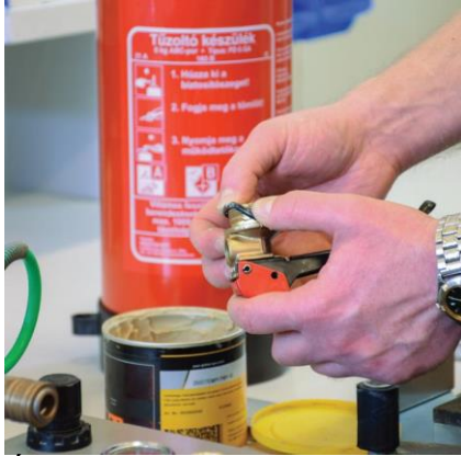
Új O-gyűrű felhelyezése minden karbantartáskor
