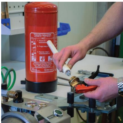
Felszállósó és nyomórugó kiemelése
