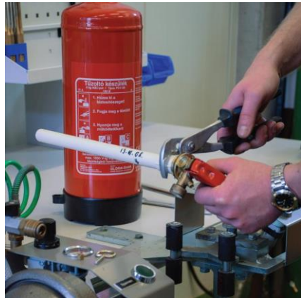
Felszállósó kitekerése a fejszerelvényből
