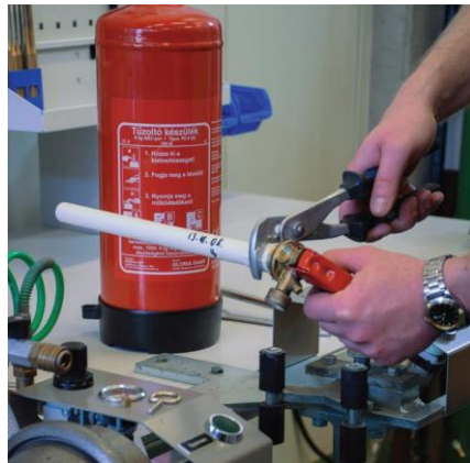
Felszállócső kitekerése a fejszerelvényből
