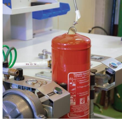
Tartály ellenőrzése tükrös tartályvizsgálóval
