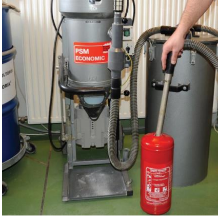
Porkiszívás zártrendszerű berendezéssel
